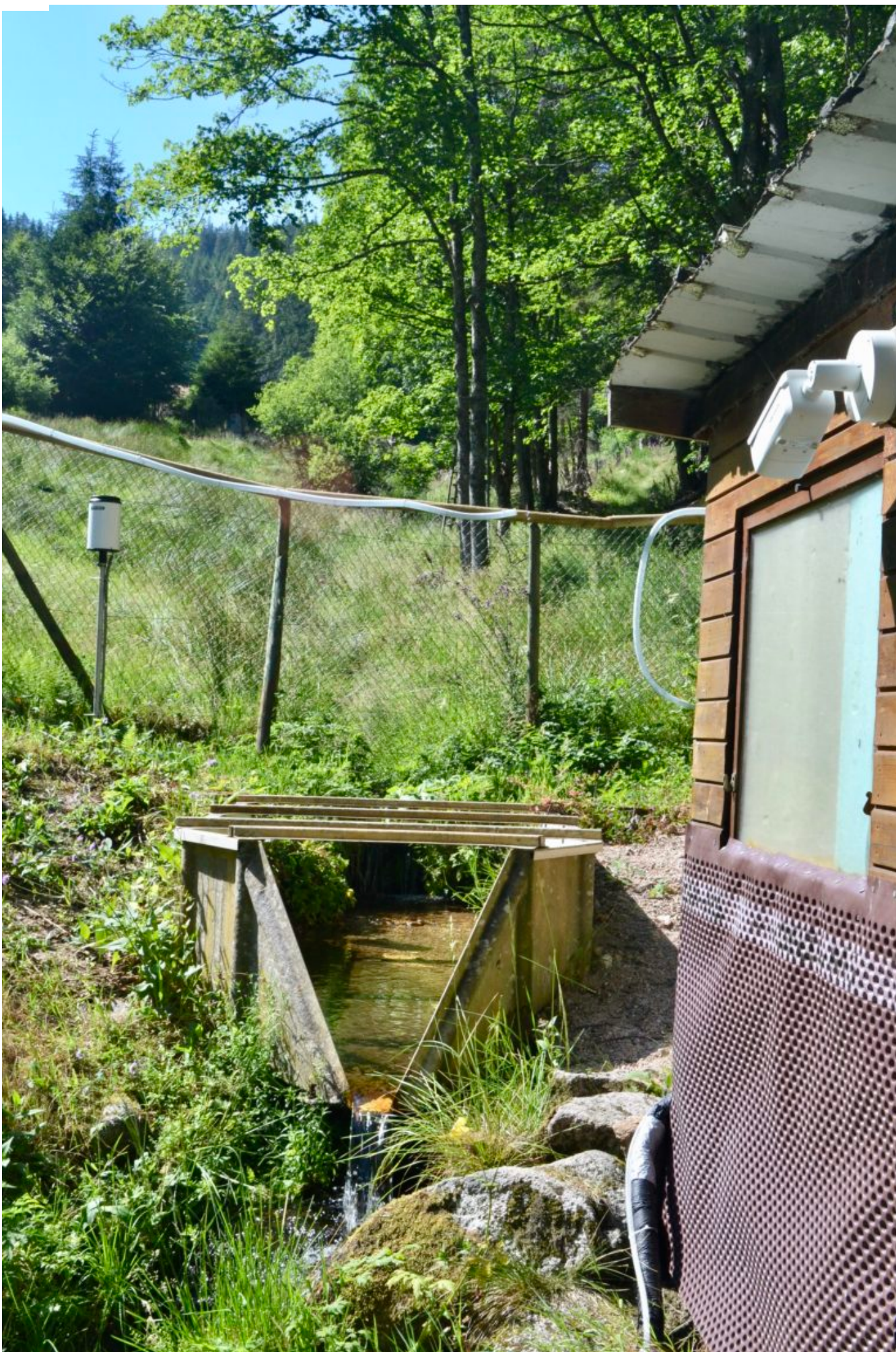
Les eaux du Strengbach sont étudiées en permanence par des système de mesure automatisés et reliés aux laboratoires
